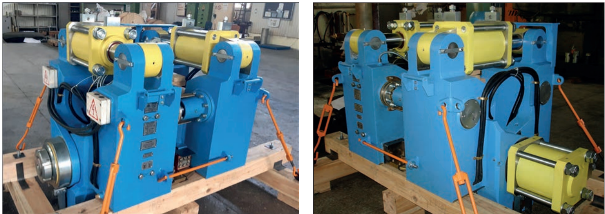
Рис. 17. Зварювальна головка машини RW1060 для КСЗО залізничних рейок у важкодоступних локаціях
