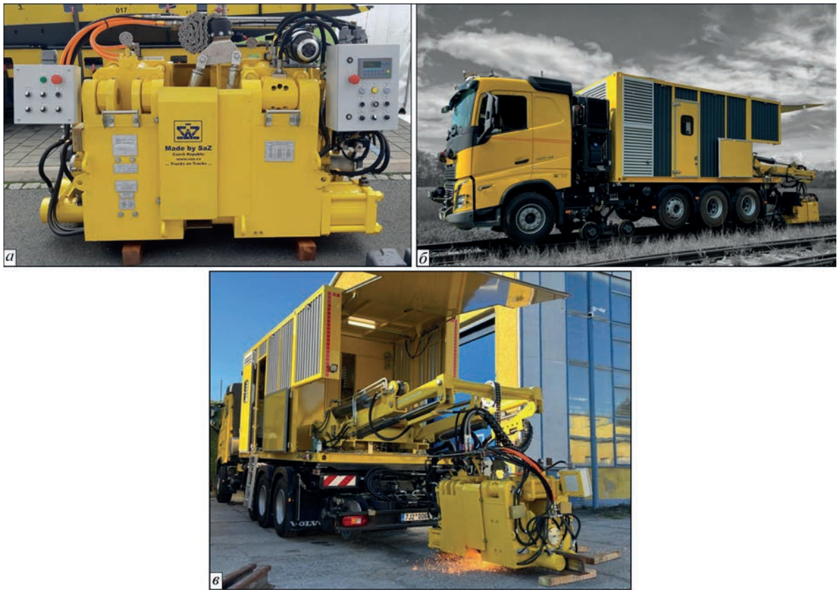
Рис. 16. Мобільна машина K922-1 (а), рейкозварювальний комплекс WELDERLINER (б, в) на комбінованому автомобільно-залізничному ходу
