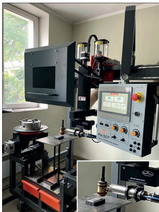
Рис. 1. Установка для плазово–порошкового наплавлення з двома живильниками порошку та плазмотроном РР–6–03
