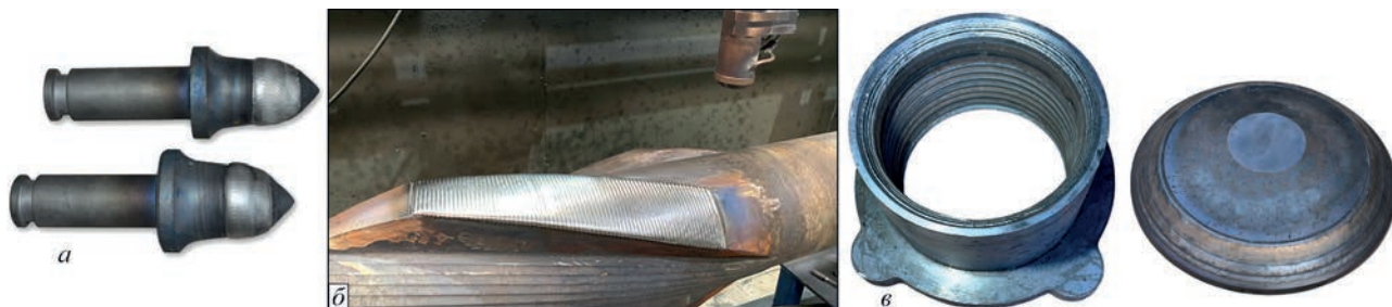
Рис. 12. Приклади ефективного застосування плазово-порошкового наплавлення композиційного сплаву з використанням сплаву-зв'язки 270Н15Д7Х3С2: а – різець тангенціальний; б – калібратор; в – клапан вирівнювальний доменної печі
