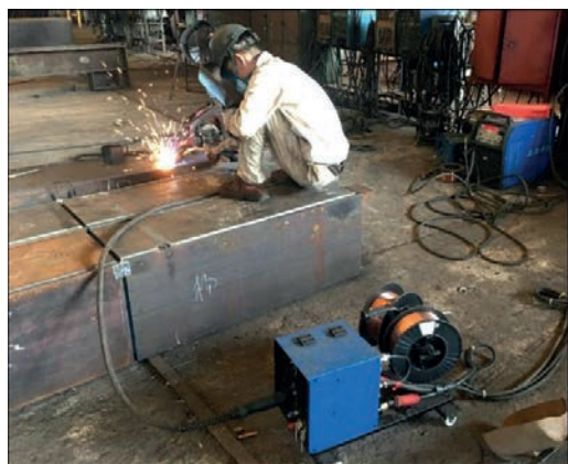
Зварювання подвійним дротом з одним джерелом живлення може застосовуватися при ручному, напівавтоматичному, та автоматичному зварюванні
