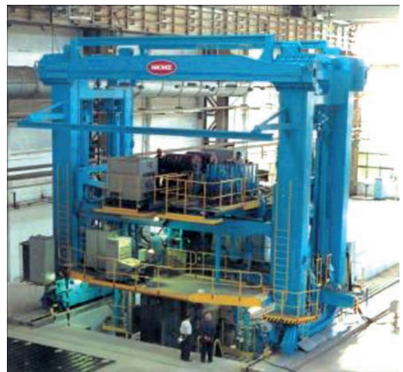
Рис. 8. Зовнішній вигляд установки ESW плавким мундштуком для з'єднання металу, зварюваний переріз якого може досягати розміру 4000×6000 мм
