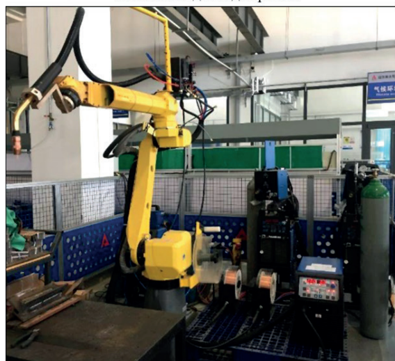
Зварювання подвійним дротом з одним джерелом живлення може застосовуватися при ручному, напівавтоматичному, та автоматичному зварюванні
