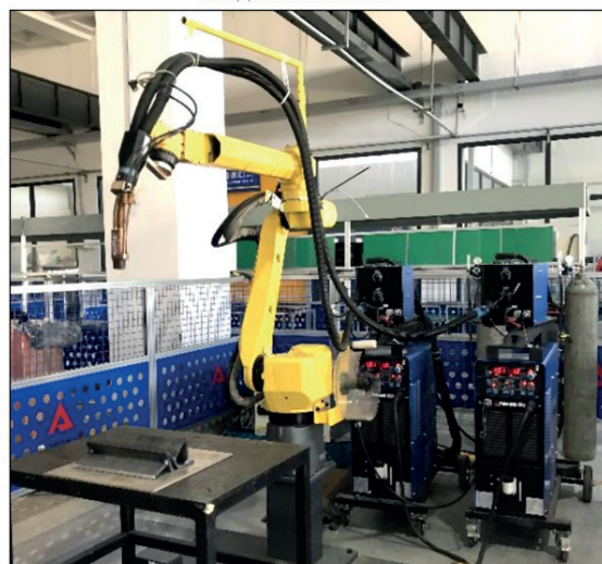
Зварювання подвійним дротом з одним джерелом живлення може застосовуватися при ручному, напівавтоматичному, та автоматичному зварюванні
