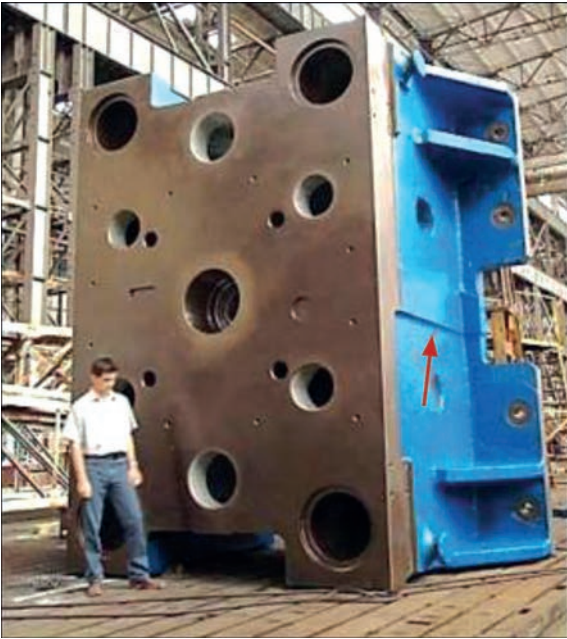
Рис. 9. Зварна заготовка траверси гідравлічного пресу. Маса заготовки 150 т, переріз шва (показано стрілкою), виконаного ESW плавким мундштуком, 2490×3860 мм
