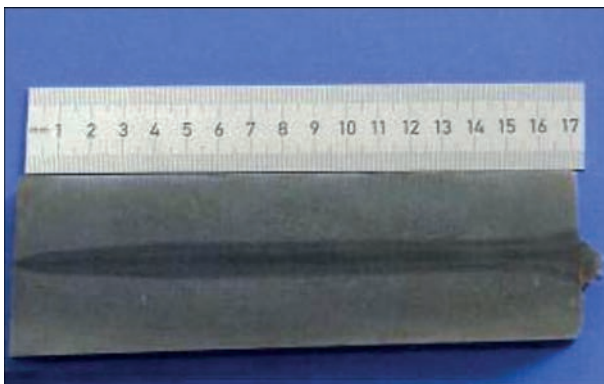
Рис. 1. Макрошліф зварного з'єднання, отриманого електронно-променевим зварюванням у вакуумі [7]
