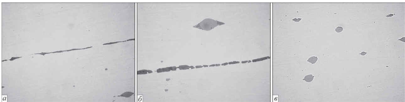
Рис. 6 Силікати пластинчасті в сталі: а – \delta = 15 мм, \times 500 ; б – ланцюжок оксидів у сталі, \delta = 15 мм, \times 500 ; в – сульфіди та оксисульфіди біля лінії сплавлення, \delta = 15 мм, \times 500
