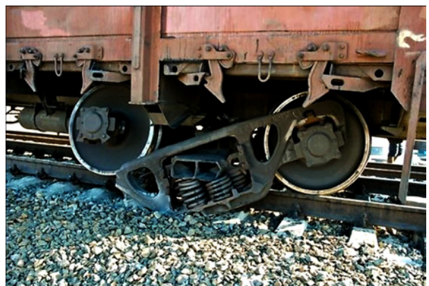
Рис. 1. Зруйнована бокова рама візка вантажного вагона, що виготовлена за ливарною технологією [1]
