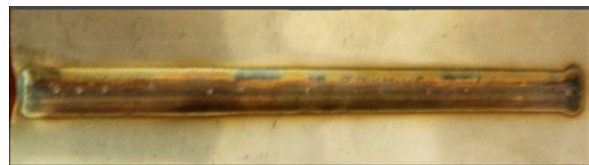
Рис. 7. Типовий прогин з тильної сторони тонкостінної основи під час наплавлення [15]
