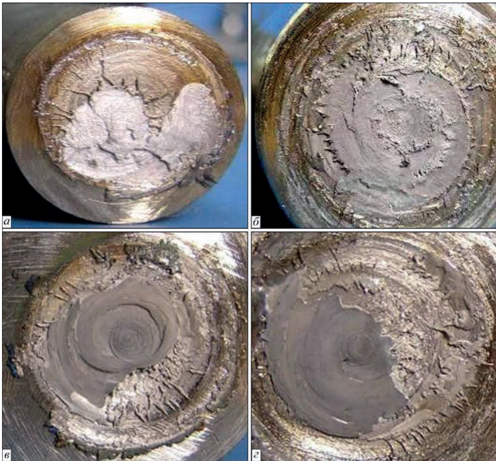
Рис. 2. Поверхні зразків після зупинки процесу ЗТ сплавів ВЖЛ12У і ЕІ698ВД: варіант 1 при часі нагрівання t_{\text{н}} = 2 с (а), 3 с (б), 4 с (в), 5 с (г)
