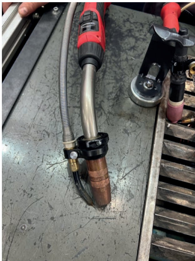
Пальник Fronius Velo з додатковим жорстким дротом суцільного перерізу
