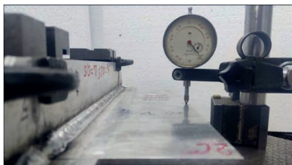
Рис. 4. Стенд для вимірювання залишкових деформацій зварених зразків
