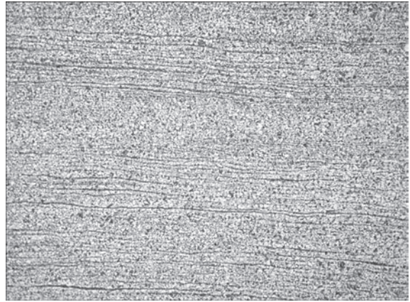
Рис. 11. ЗТВ, ділянка повної перекристалізації, \times 100
