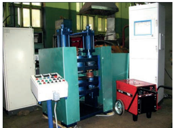
Рис. 7. Зварювальна установка МД205
