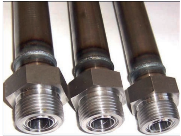
Рис. 16. Зварювання труб з фітингами для гідравлічних систем будівельних машин
