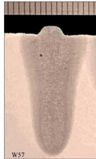
Рис. 2. Зварний шов, виконаний у нижньому положенні, з низьколегованої сталі з імпульсним променем NVEB, глибина провару 22 мм [7]
