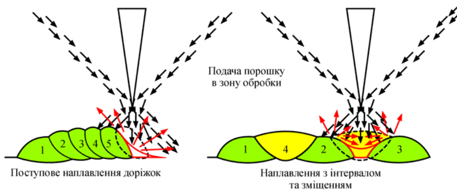
Рис. 4. Схематичне зображення розподілу порошку при використанні інтервалів при напавленні доріжок
