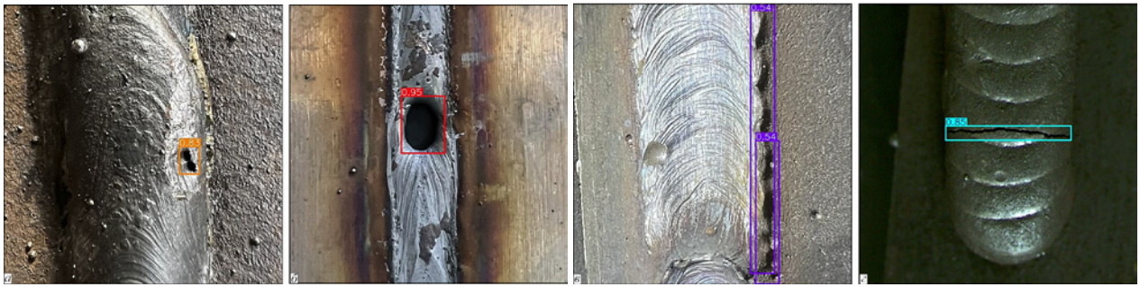
Рис. 7. Результат розпізнавання поверхневих дефектів базовою моделлю YOLOv5, що навчена на зварювальному наборі даних: a – поверхневі пори; б – пропал; в – підріз; г – поперечна тріщина
