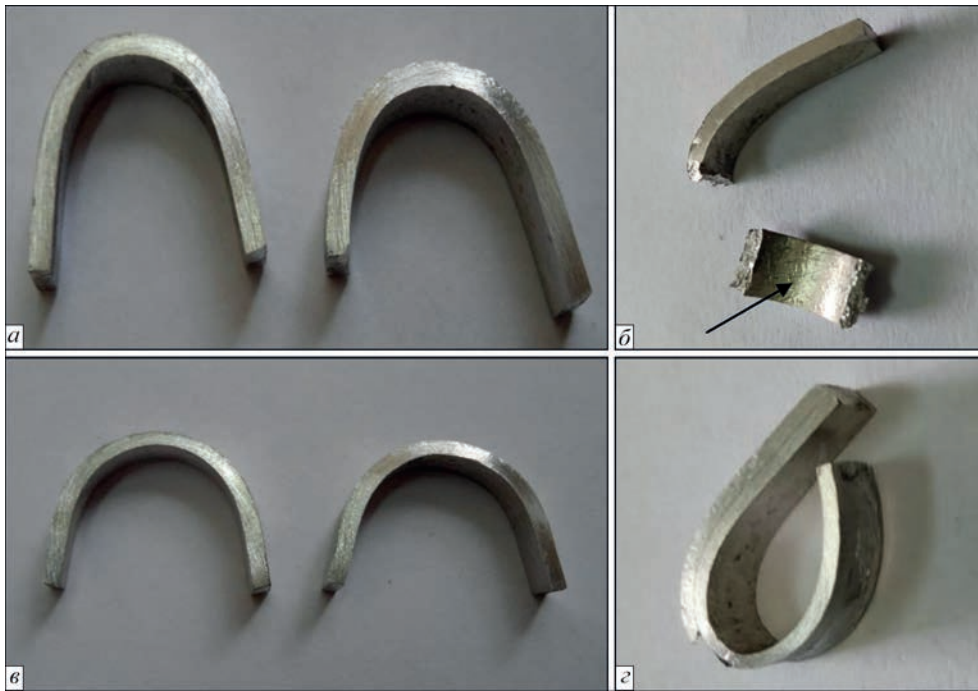
Рис. 8. Загальний вигляд зразків після проведення випробувань на загин (а, б) і внутрішня поверхня зламу (б, г) із перфорованими прошарками: а, б – нікелева фольга; в, г – титанова фольга
