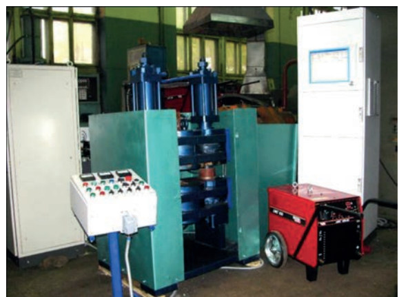
Рис. 7. Зварювальна установка МД205
