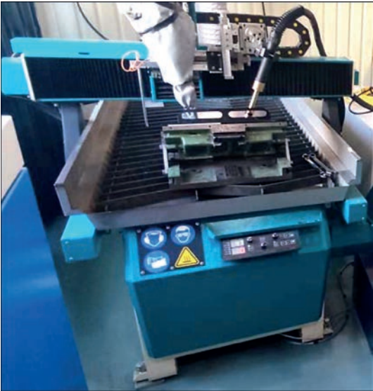
Рис. 1. Лабораторний стенд для MIG і QCW лазер-MIG зварювання таврових і стикових зразків зі сплаву 5083 завтовшки \delta = 4 мм
