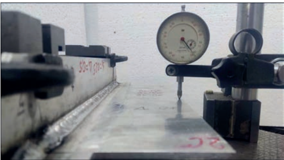
Рис. 4. Стенд для вимірювання залишкових деформацій зварених зразків
