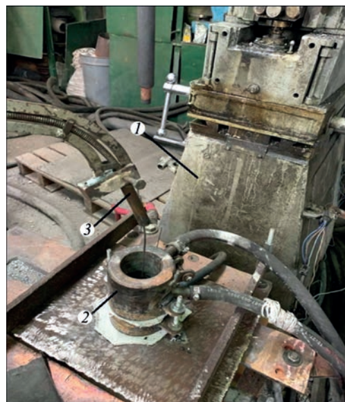
Рис. 2. Обладнання та пристрої для наплавлення, підготовлені до наплавлення порошковим дротом: 1 – апарат А-550; 2 – СПК; 3 – пристрій для подачі порошкового дроту в шлакову ванну
