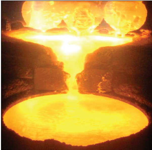
Рис. 4.14. Процес ЕПП зливка Ø 400 мм
