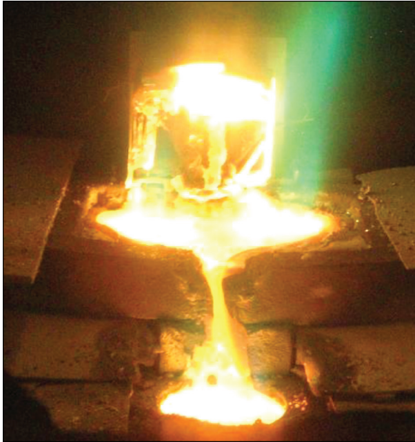
Рис. 4.15. Процес ЕПП зливка Ø 110 мм
