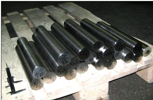
Рис. 5.10. Пресовані прутки \varnothing 60 мм з титанового сплаву ВТ22
