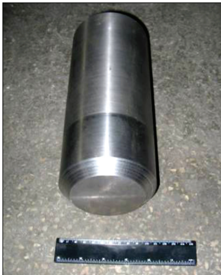
Рис. 4.21. Механічно оброблений зливков сплаву титану ВТ19
