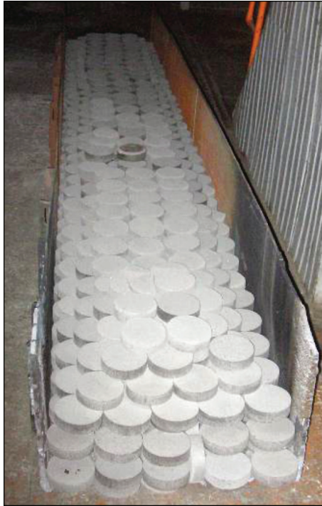
Рис. 4.12. Шихтова заготовка для виплавки зливка титанового сплаву ВТ22
