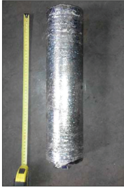
Рис. 3.6. Поверхня зливка Ø 110 мм, виплавленого за режимом 2
