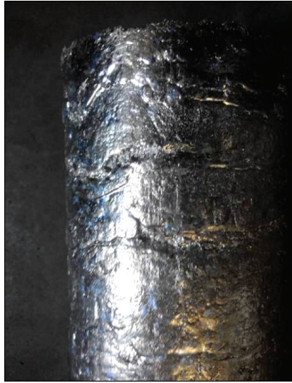
Рис. 3.4. Поверхня зливка \varnothing 110 мм, виплавленого за режимом 1
