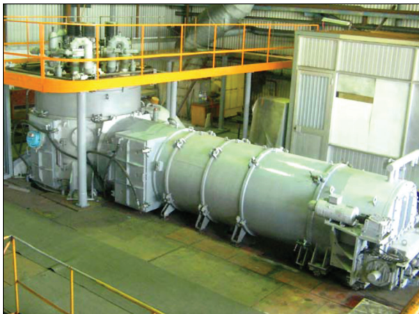
Рис. 4.4. Зовнішній вигляд промислової електронно-променевої установки УЕ-5812
