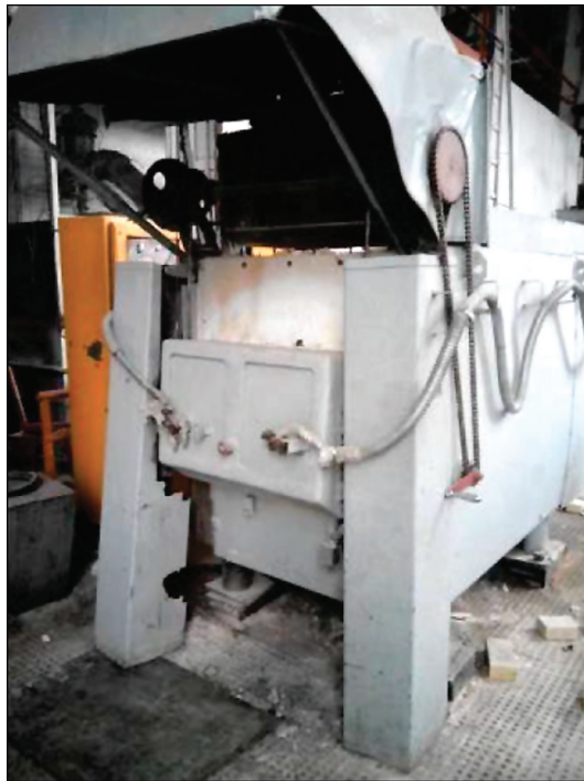
Рис. 5.3. Зовнішній вигляд печі опору потужністю 70 кВт
