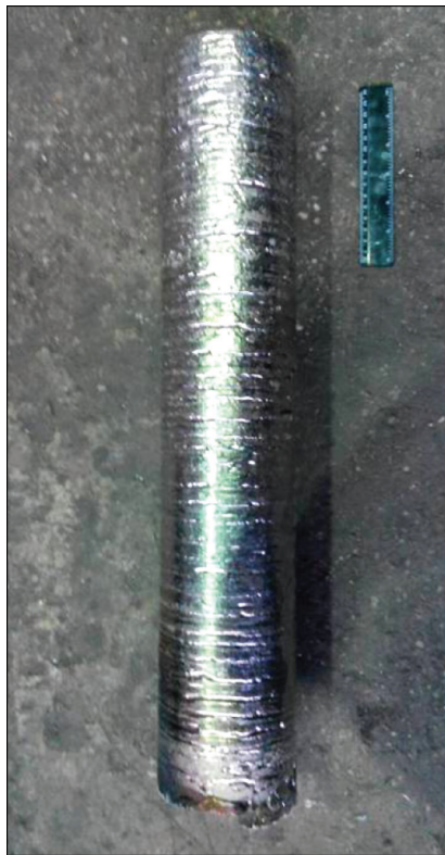
Рис. 3.5. Поверхня зливка \varnothing 110 мм, виплавленого за режимом 3
