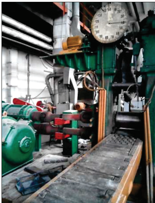
Рис. 5.1. Зовнішній вигляд реверсивного дуо-стану Skoda 355/500
