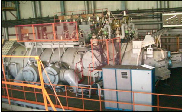
Рис. 4.7. Зовнішній вигляд електронно-променевої установки UE-5810
