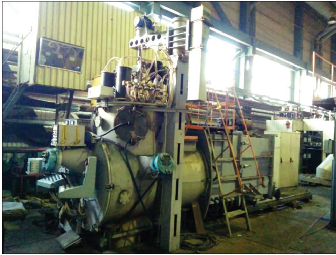
Рис. 2.6. Зовнішній вигляд лабораторної електронно-променевої установки UE-208M
