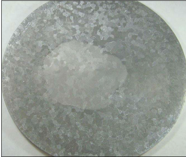
Рис. 3.8. Ліквация хімічних елементів осьової частини зливка Ø 110 мм
