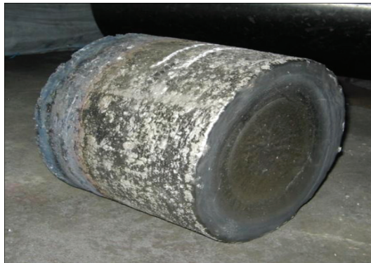
Рис. 4.5. Злипок алюмініду титану Ti–29Al Ø 300 мм
