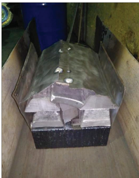
Рис. 4.4. Зовнішній вигляд шихтових заготовок для виплавки зливка алюмініду титану \varnothing 300 мм Ti-29Al
