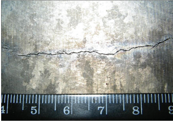
Рис. 3.20. Радіальна тріщина зливка ЕПП Тi–29Al Ø 300 мм
