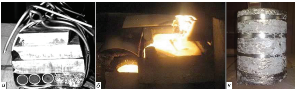
Рис. 4.8. Шихтова заготовка (а), процес плавки (б) та отриманий зливки \varnothing 165 мм сплаву 29Al-12Nb-3Cr-3Zr-0.3B-0.01La (в)
