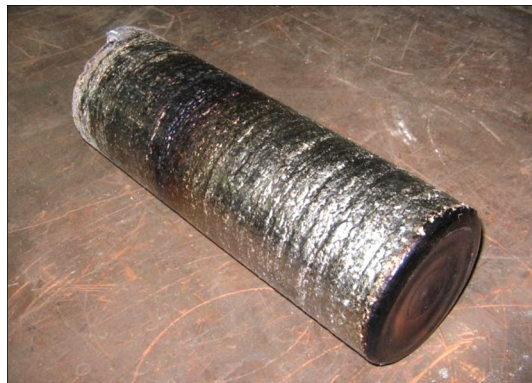
Рис. 4.7. Зливоч алюмініду титану складом Ti-28Al-7Nb-2Mo-2Cr Ø 200 мм
