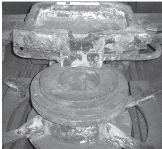
Рис. 4.2. Технологічна оснастка для отримання зливків сплавів на основі алюмініду титану
