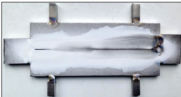
Рис. 4.15. Зразок зварного з'єднання псевдо- \beta титанового сплаву ВТ19, зібраний під АДЗ вольфрамовим електродом з нанесеним флюсом АНТ-25
