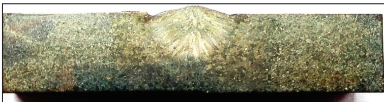
Рис. 4.17. Поперечний макрошліф зварного з'єднання псевдо- \beta титанового сплаву ВТ19, виконаного АДЗ вольфрамовим електродом по шару флюсу
