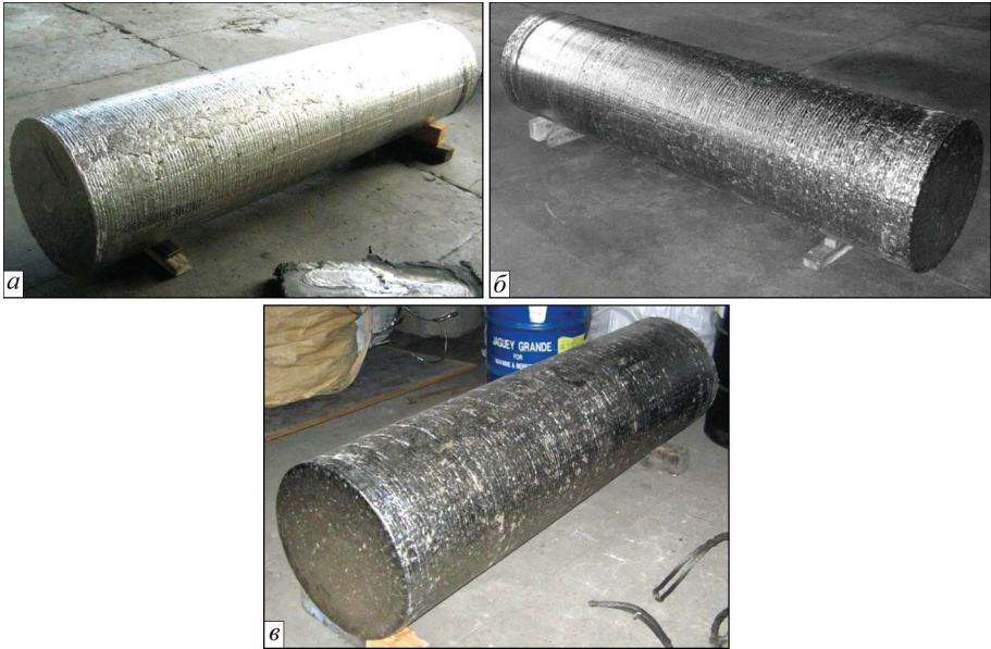
Рис. 3.10. Зливки високоміцних сплавів титану: a — \varnothing 500 мм ВТ20; б — \varnothing 400 мм ВТ23; в — \varnothing 600 мм ВТ14
