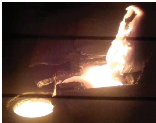
Рис. 3.16. Процес ЕПП зливка Ø 110 мм титанового сплаву Т120
