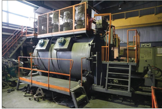
Рис. 1.22. Зовнішній вигляд спеціалізованої електронно-променевої установки UE-185 для оплавлення зливків
