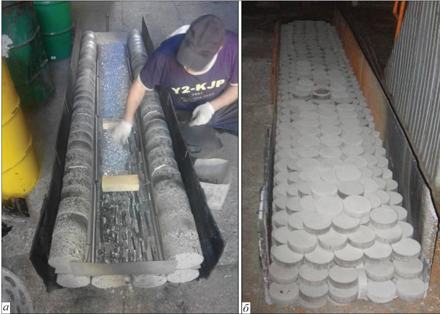
Рис. 3.5. Шихтові заготовки для виплавки зливок титанових сплавів: а — VT20; б — VT23
