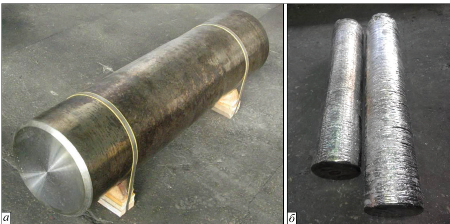
Рис. 3.18. Зовнішній вигляд зливка: а — Ø 400 мм титанового сплаву Т110; б — Ø 150 мм титанового сплаву Т120
