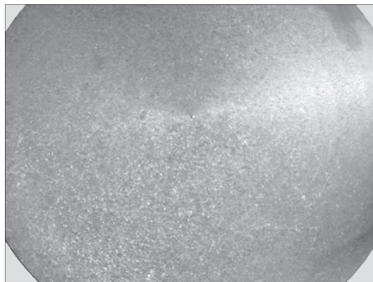
Рис. 4.12. Макроструктура кованого прутка Ø 200 мм із титанового сплаву ВТ14
