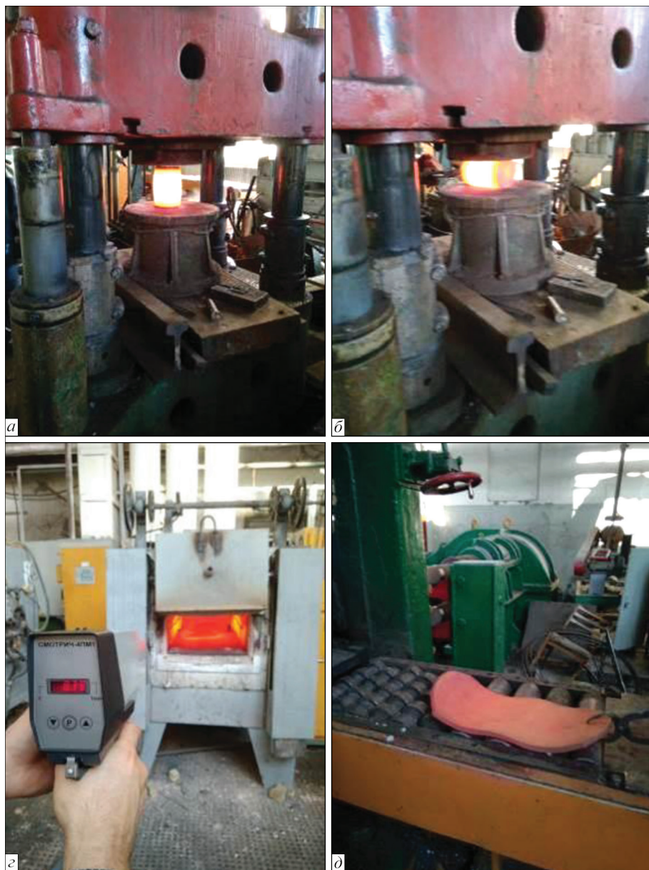
Рис. 4.17. Етапи деформаційної обробки сплаву Т110 ЕПП для забезпечення найкращого структурно-фазового стану металу: а, б — пресування; в — нагрівання; г — прокатування
