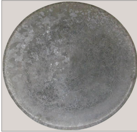
Рис. 3.22. Макроструктура металу зливка жароміцного титанового сплаву ВТ9 Ø 600 мм з оплавленою бічною поверхнею
