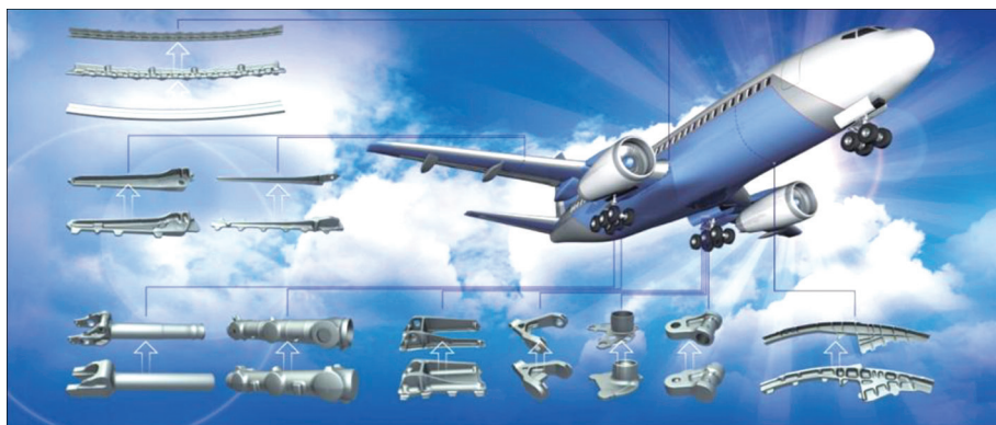
Рис. 1.12. Застосування сплавів титану у виробництві силових елементів крила та фюзеляжу літака
