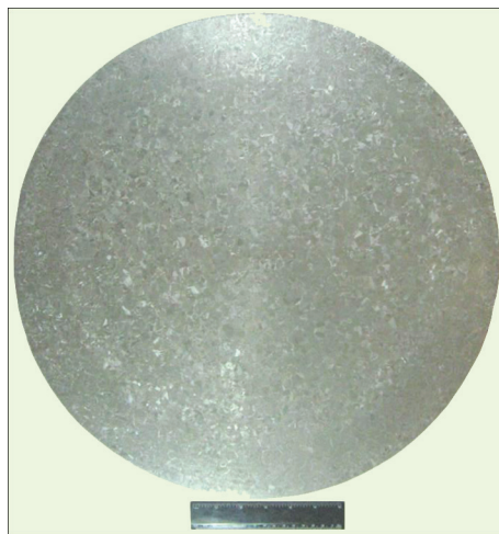
Рис. 3.13. Макроструктура зливка Ø 400 мм титанового сплаву BT23, отриманого методом ЕПП
