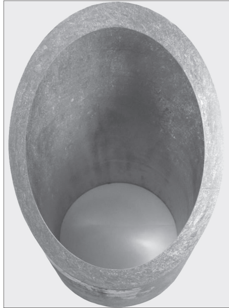
Рис. 4.7. Макроструктура гарячекатаної труби 114×15 мм із титанового сплаву ВТ20
