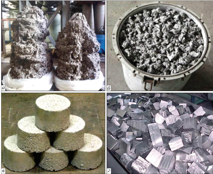
Рис. 3.1. Шихтові матеріали, що застосовуються при виготовленні методом ЕПП зливок високоміцних сплавів титану: a — недроблені блоки губчастого титану; b — фракційний губчастий титан; c — брикетований губчастий титан; d — відходи титанового виробництва
