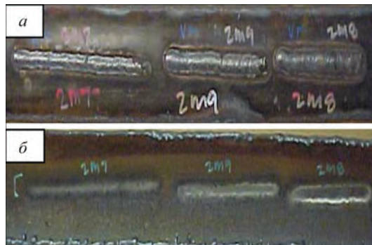
Рис. 5.29. Наплавлені валики на поверхні труби (товщина стінки 3,2 мм; тиск метану 4,5 МПа; швидкість потоку газу 6,1 м/с) (а) і сліди температурного поля на внутрішній поверхні (б) [5.6]
