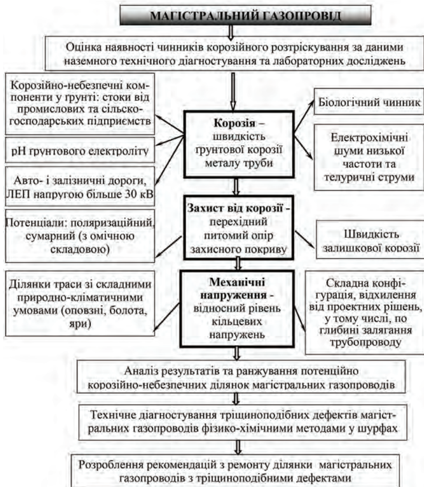
Рис. 3.19. Алгоритм визначення потенційно корозійно-небезпечної ділянки магістрального газопроводу в умовах катодного захисту за даними наземного технічного діагностування та лабораторних досліджень
