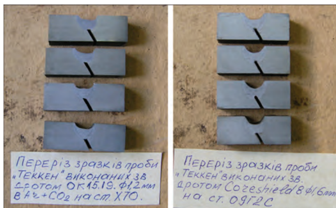
Рис. 5.10. Зовнішній вигляд зразків після обстеження на холодні тріщини
