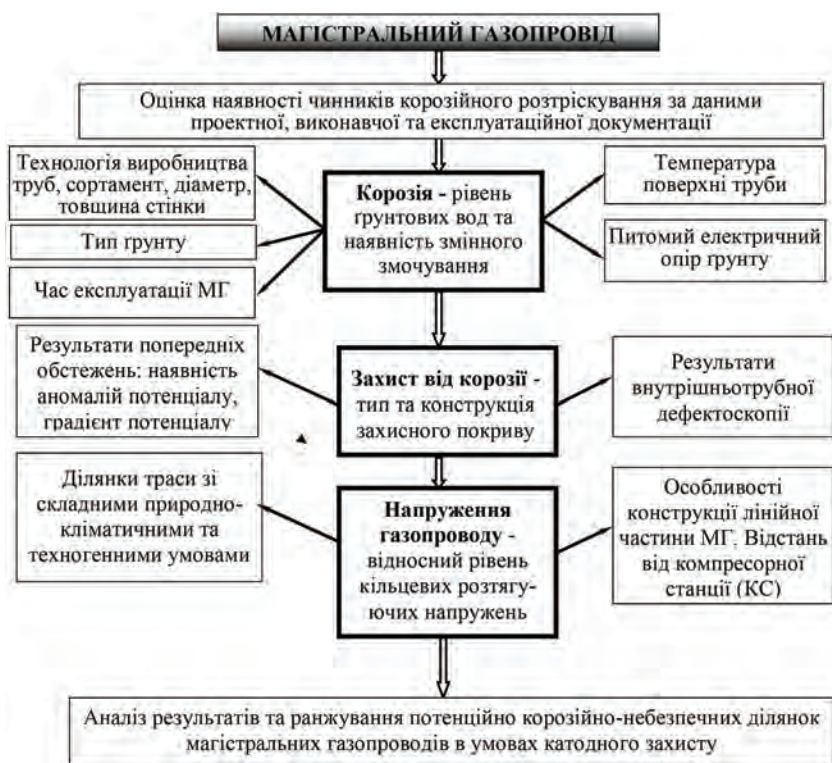
Рис. 3.18. Алгоритм визначення потенційно корозійно-небезпечної ділянки магістрального газопроводу в умовах катодного захисту за даними проєктної, виконавчої та експлуатаційної документації
