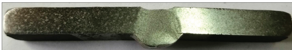
Рис. 4.19. Поперечний макрошліф з'єднання економнолегованого титанового псевдо- \beta сплаву Ti-2.8Al-5.1Mo-4.9Fe, виконаного АДЗ по шару флюсу
