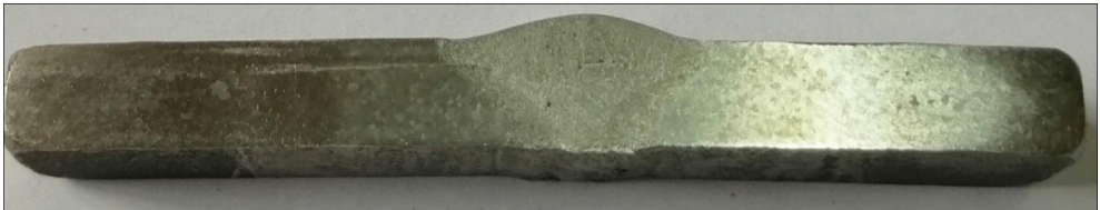
Рис. 4.4. Поперечний макрошліф з'єднання економнолегованого титанового псевдо- \beta сплаву Ti-2.8Al-5.1Mo-4.9Fe , виконаного АДЗ з додаванням присадного дроту у кількості 10 %
