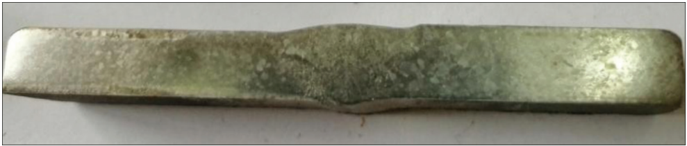
Рис. 4.3. Поперечний макрошліф з'єднання економнолегованого титанового псевдо- \beta сплаву Ti-2.8Al-5.1Mo-4.9Fe , виконаного АДЗ наскрізним проплавленням без присадного дроту
