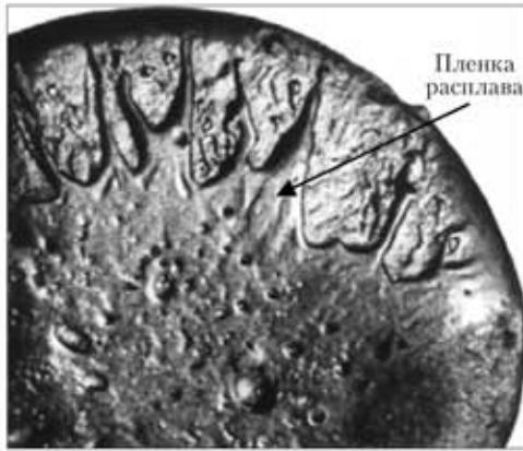
Рис. 2. Характер плавления торца стержня при термоцентробежном распылении
