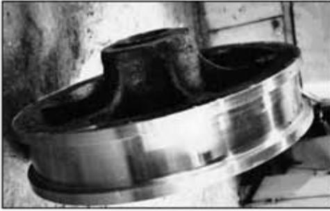
Рис. 3. Внешний вид наплавленного и обработанного колеса
