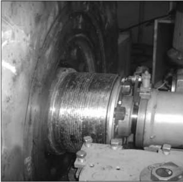
Рис. 6. Наплавленный вал привода эскалатора метрополитена
