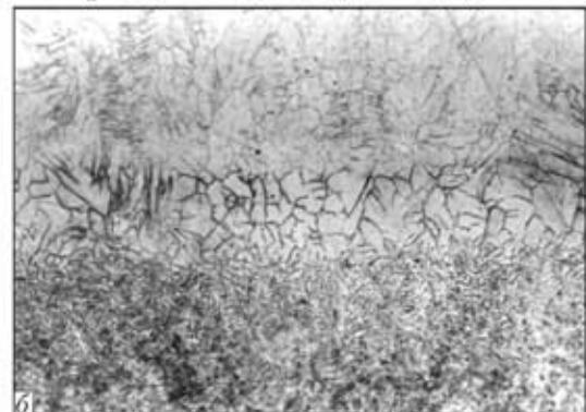
Рис. 1. Схематическое представление интервала  $T_L - T_S$  для ОМ (сталь P91), собственно наплавленного металла сварочной проволокой ПП9 и металла однослойной наплавки валика на сталь в однородном соединении типа М–М (а) и микроструктура металла в ЗС (б),  $\times 250$
