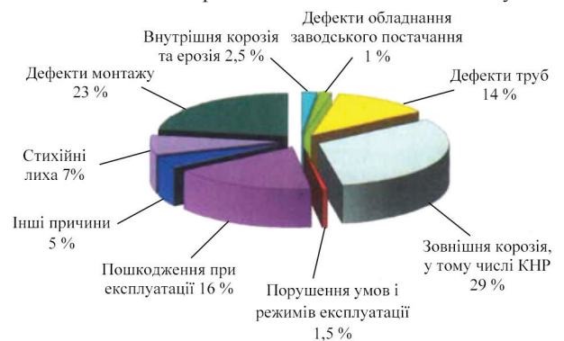
Рис. 2. Основні причини відмови трубопроводів
