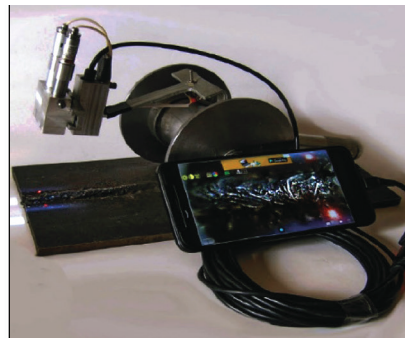
Рис. 15. Конструктивна схема (а) та зовнішній вигляд (б) пристрою ВБК/ТВА з двома лазерними вказівниками для вимірювання ширини шва, USB веб-камерою та двома підсвічуваннями наковалюшовної зони
