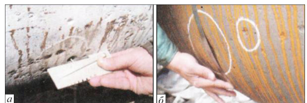
Рис. 4. Дефекти корозії і механічні ушкодження: а — виразки; б — вм'ятини
