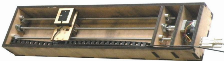
Рис. 1. Рентгентелевизионный сканирующий детектор
