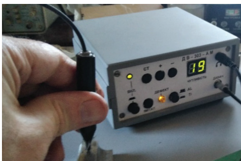
Рис. 3. Діючий макет автогенераторного ВД з «олівцевим» ВСП
