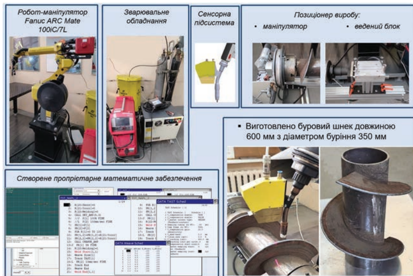
Рис. 4. Підготовлена діюча модель робототехнічної системи WAAM технології
