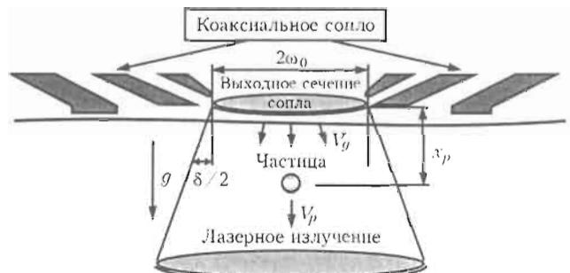
Рис. 2. Схема физической модели нагрева и транспорта частицы порошка при лазерной наплавке
