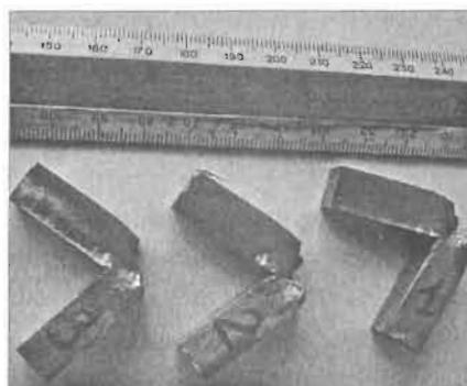
Рис. 18. Образцы металла модельного слитка диаметром 110 / 180 мм из стали 316, вырезанные согласно рис. 16, после испытаний на ударную вязкость
