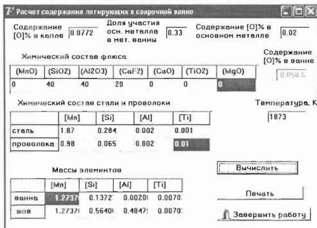
Рис. 1. Интерфейс компьютерной программы для численного моделирования перехода легирующих элементов в жидкую ванну и металл шва при сварке под флюсом
