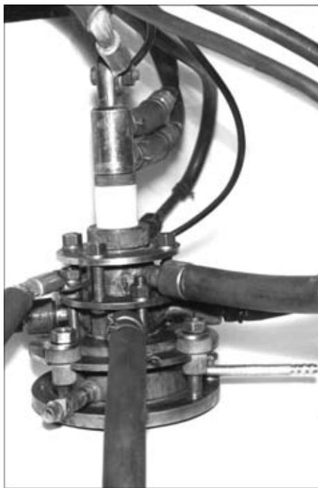
Рис. 3. Камера открытого типа с дуговым плазмотроном
