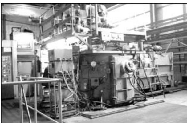
Рис. 1. Внешний вид электронно-лучевой установки УЭ-121
