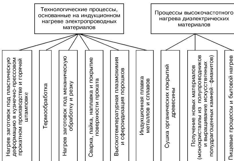
Рис. 1. Классификация процессов и установок, использующих индукционный нагрев
