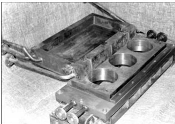
Рис. 2. Технологическая оснастка для одновременной плавки нескольких слитков
