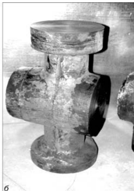
Рис 3. Схема (а) и внешний вид (б) заготовки корпуса ствольной задвижки ФА с проходным сечением диаметром 80 мм, полученной методом электрошлакового литья (тонкими линиями указан наружный контур готовой детали)
