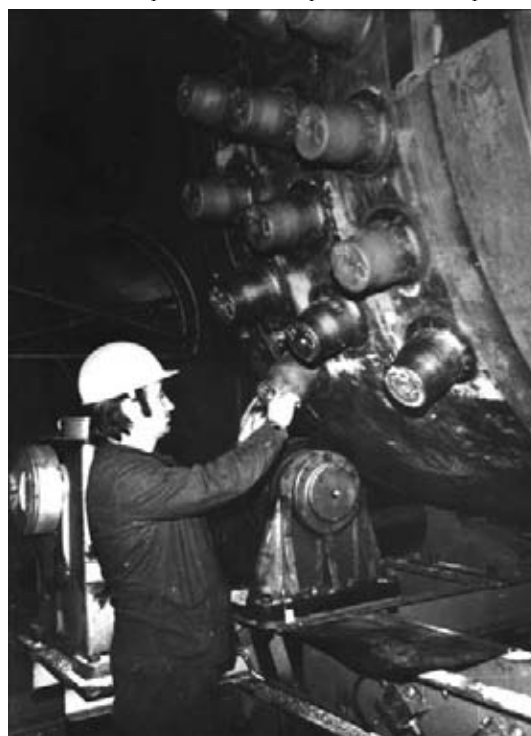
Рис. 9. Заготовки патрубков, выплавленные методом ЭШЛ непосредственно на корпусе сосуда
