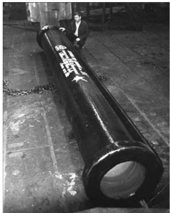
Рис. 11. Общий вид длинномерной пустотелой двухфланцевой заготовки ЭШЛ диаметром 600 мм
