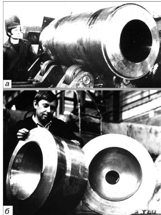
Рис. 5. Обечайка (а) и днище (б) из аустенитной стали 12Х18Н10ТШ-Л, подготовленные к автоматической сварке криогенного сосуда высокого давления, предназначенного на рабочее давление 70 МПа и температуру -196^{\circ}\text{C}
