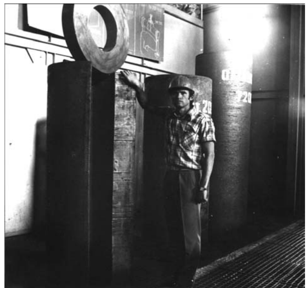
Рис. 4. Полые слитки из стали 20 и 12Х18Н10Т (диаметр 710 мм, толщина стенки 170 мм), изготовленные методом ЭШЛ, для обечаек сосудов высокого давления
