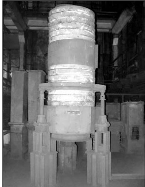
Рис. 3. Общий вид физической модели электрокальцинатора
