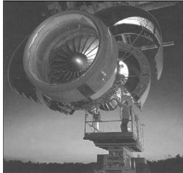
Рис. 4. Двигатель PW-2337 на техническом обслуживании
