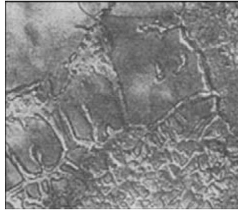
Рис. 2. Микроструктура высокопрочного литейного жаропрочного сплава. Эвтектика  $\gamma + \gamma'$  ( $\times 8000$ )
