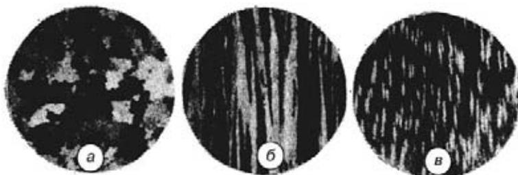
Рис. 1. Макроструктура жаропрочных сплавов в лопатках ГТД: а — равноосная; б — направленная столбчатая; в — монокристаллическая (×300)
