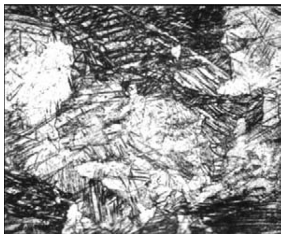
Рис. 3. Микроструктура (X100) горячекатаных труб
