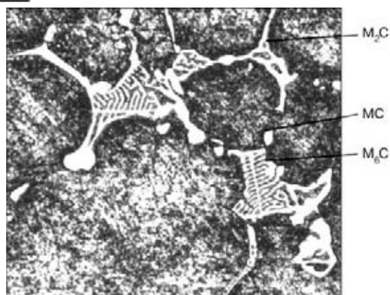
Рис. 2. Морфология эвтектики в литой стали Р6М5 (ЭЛППЕ), \times 1200
