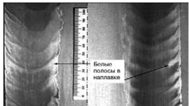
Рис. 4. Белые полосы в макроструктуре наплавки
