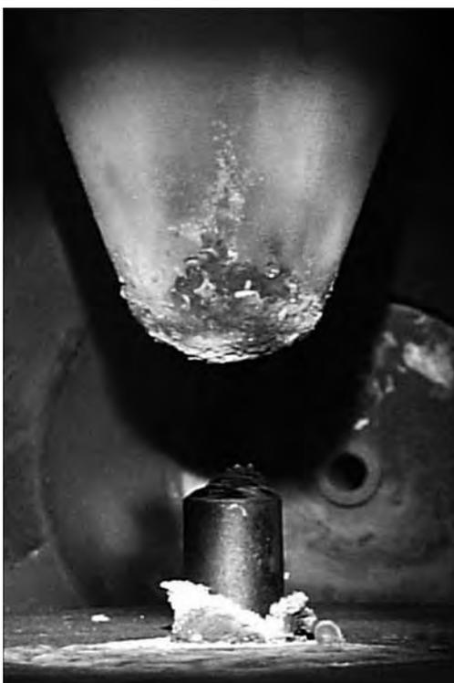
Рис. 1. Размещение электродов в камере
