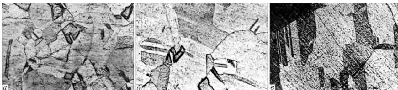
Рис. 3. Микроструктура ( $\times 100$ ) электродов цилиндрической (а), сферической (б) и конической (в) форм
