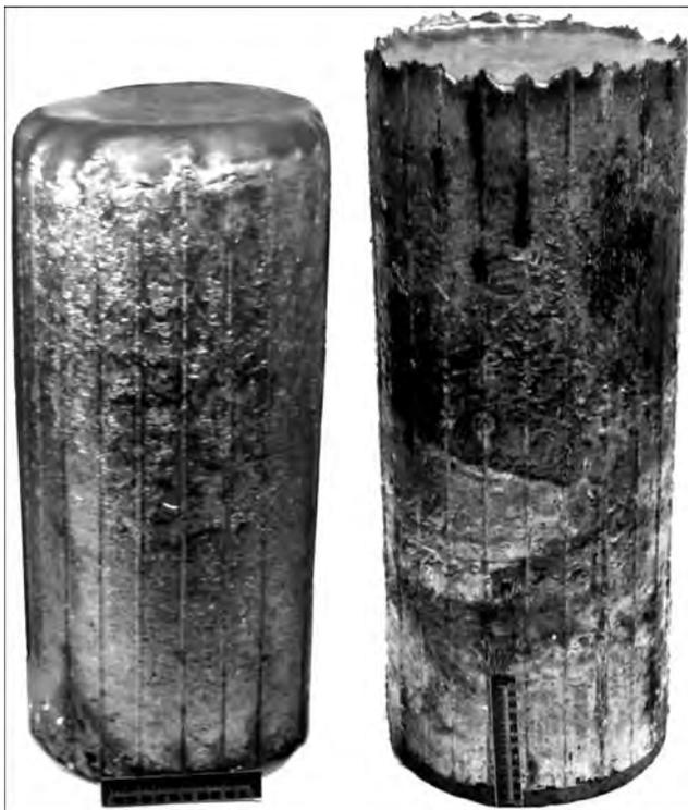
Рис. 4. Промышленные слитки, выплавленные из отходов титанового сплава ОТ4-2
