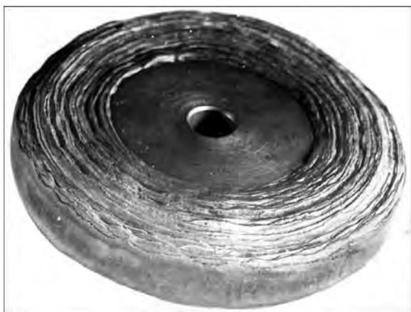
Рис. 8. Внешний вид заготовки диаметром 180 мм (типа диска), полученной послойным намораживанием
