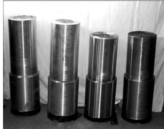
Рис. 11. Заготовки сталемедных подовых электродов
