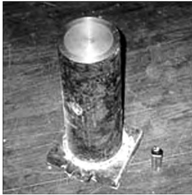
Рис. 7. Заготовка подового электрода, состоящая из стальной трубы, заполненной способом ЭШП медью
