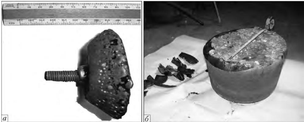
Рис. 2. Медные отливки, полученные на установках А-550 (а) и УШ-159 (б)
