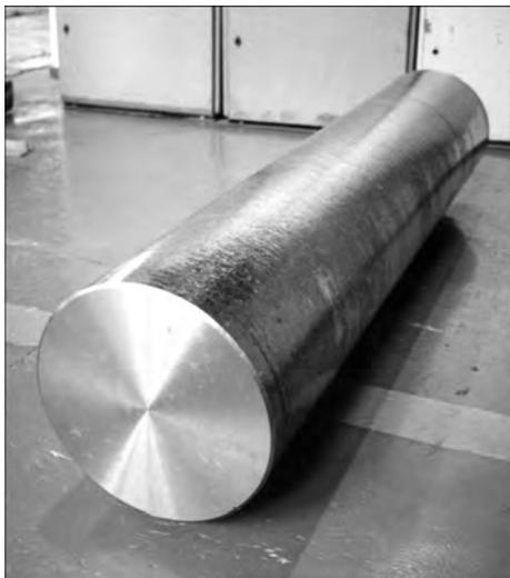
Рис. 3. Внешний вид слитка титанового сплава Grade 12 диаметром 600 мм
