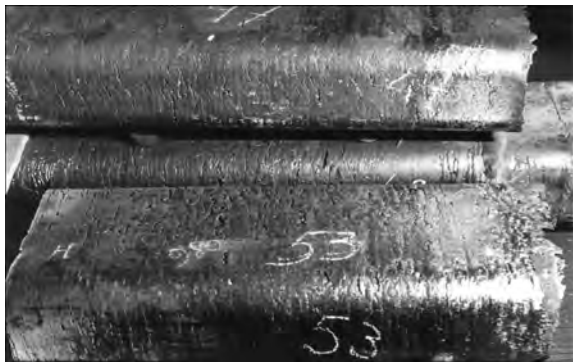
Рис. 1. Слитки плазменной плавки из 100 % отходов губчатого титана
