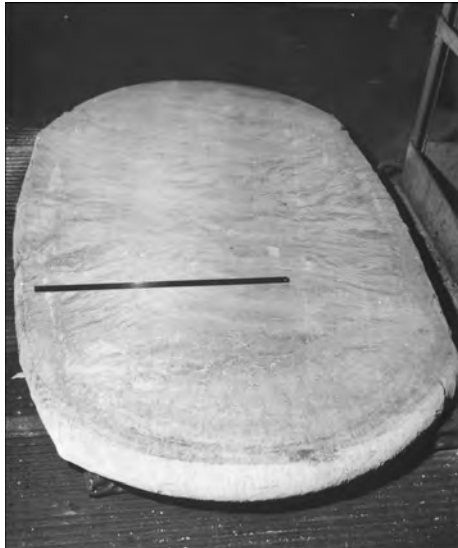
Рис. 2. Общий вид поковки из слитка размерами (50...80) × (700...800) × (800...1000) мм из слитка плазменной плавки
