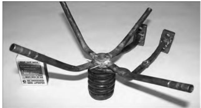
Рис. 6 Внешний вид двухсекционного кристаллизатора ( $d = 10$  мм) в индукторе
