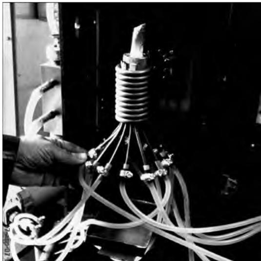
Рис. 7. Шестисекционный ступенчатый кристаллизатор ( $d = 20/2$  мм) в индукторе
