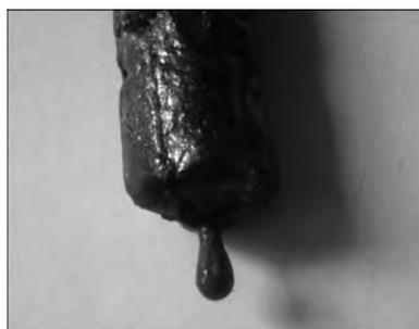
Рис. 8. Затвердевший металл на выходе из сливного отверстия
