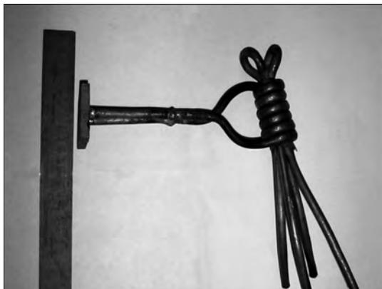
Рис. 5. Секционный кристаллизатор ( $d = 3$  мм) в индукторе
