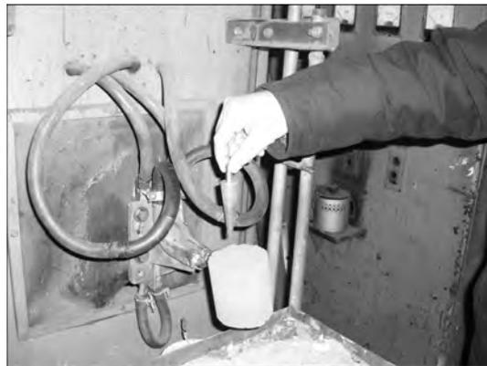
Рис. 11. Внешний вид индукционной мини-печи
