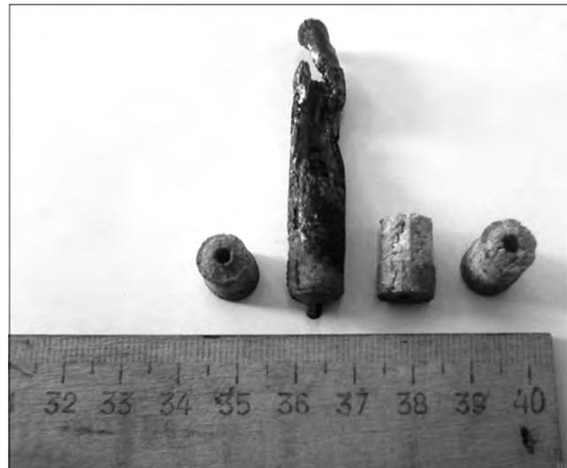
Рис. 9. Внешний вид керамического вкладыша со сливным отверстием диаметром 2 мм
