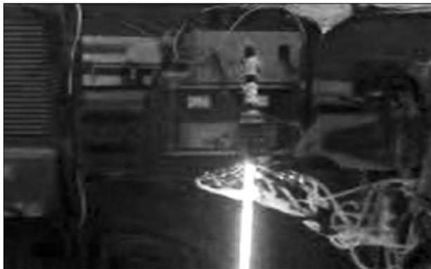
Рис. 10. Вытекание струи жидкого металла через сливное отверстие диаметром 2 мм
