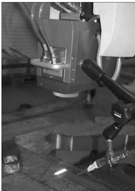
Лазерное термоупрочнение пресс-формы (Erlas Hard+Clad)
