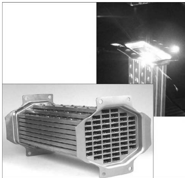
Дистанционная лазерная сварка теплообменника (ROFIN Scan Welding System)
