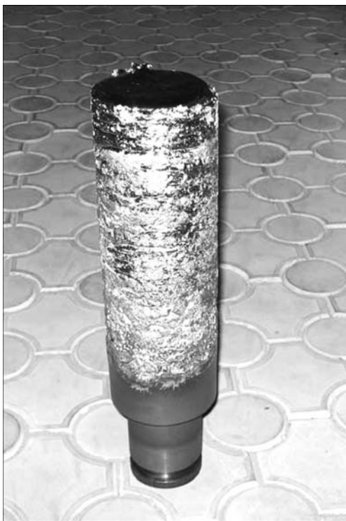
Рис. 3. Слиток молибдена ЭЛПЕ диаметром 100 мм
