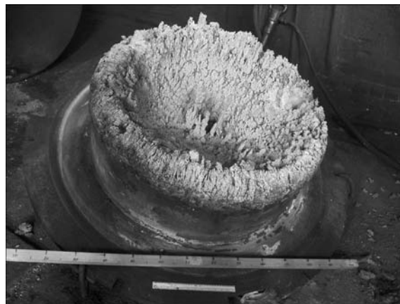
Рис. 1. Реакционная масса на крышке аппарата восстановления
