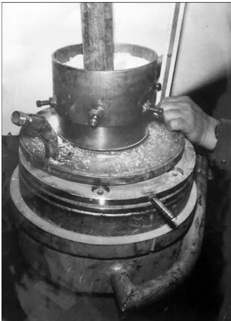
Рис. 3. Флюсовый затвор с устройством для продувки аргоном
