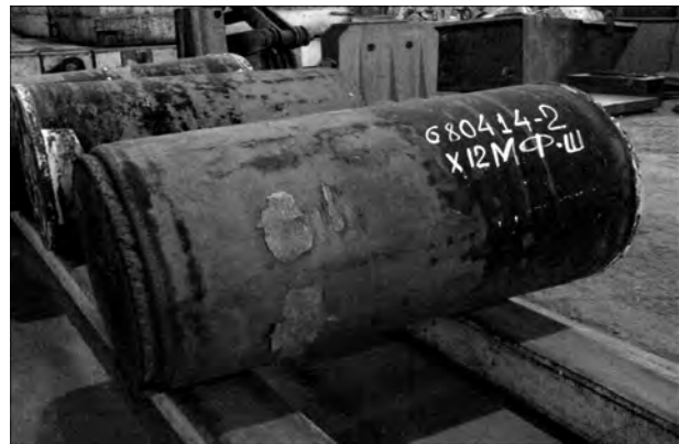
Рис. 6. Слитки ЭШП диаметром 800 мм стали X12MФ-Ш, выплавленные при ЭШП электрода сечением 370×370 мм с подъемом вводимой мощности
