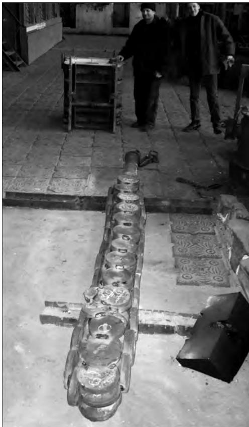
Рис. 1. Составной расходимый электрод из отходов сплава ХН73МБТЮ
