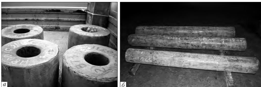
Рис. 6. Полуфабрикаты из жаропрочного титанового сплава ВТЗ-1: а – поковки; б – прутки
