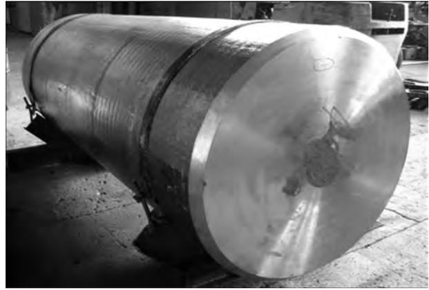
Рис. 4. Слиток жаропрочного титанового сплава ВТЗ-1 диаметром 840 мм, длиной 4000 мм
