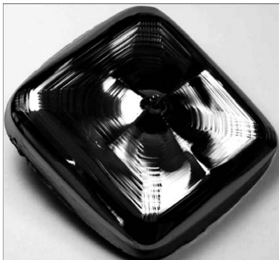
Рис. 4. Монокристалл кремния, выращенный способом Степанова [12]
