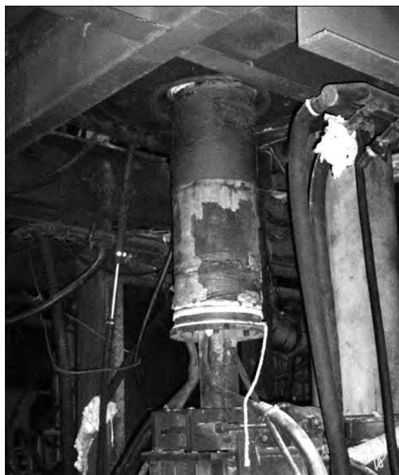
Рис. 7. Вытяжки из кристаллизатора сталемедного слитка
