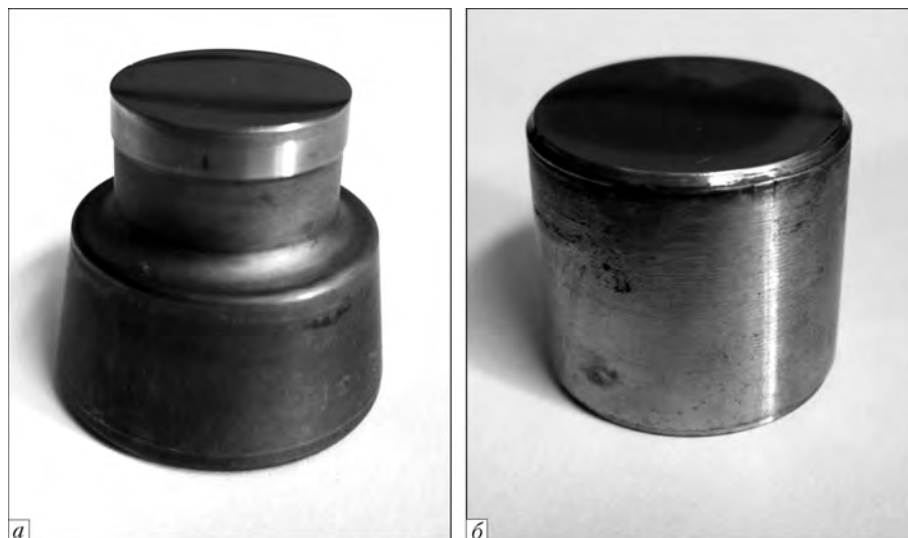
Рис. 1. Заготовки чеканочного инструмента из стали 5XB2C: а – стандартная; б – полученная способом электронно-лучевого переплава с промежуточной емкостью (ЭЛПЕ)
