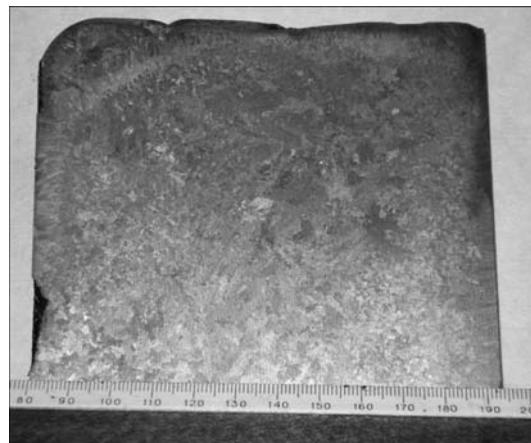
Рис. 5. Макроструктура поперечного сечения квадратного слитка стали ЭП609-Ш плазменно-дугового переплава в проходной кристаллизатор
